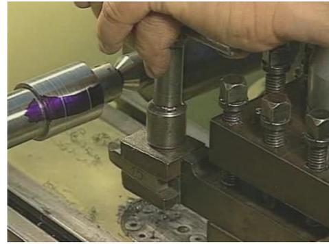
Figura 4-25.1 – Colocação da ferramenta de perfilar.
