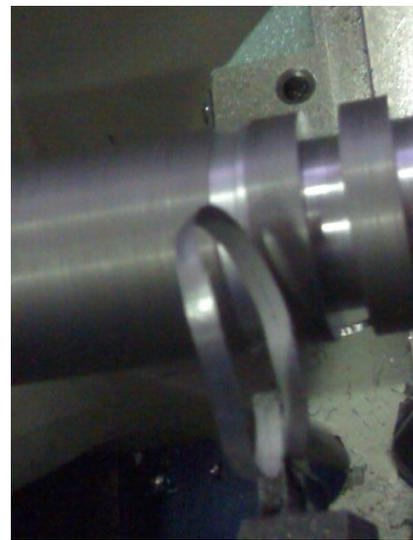
Figura 2-28.2 – Início da operação de sangramento para abertura de canal, aprofundamento da ferramenta.
