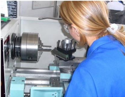
Figura 1-22.1 – Torneamento de superfície cilíndrica externa.
