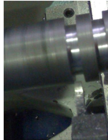
Figura 7-28.2 - Acabamento da lateral esquerda do canal.
