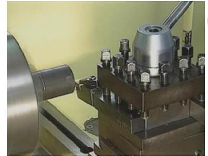
Figura 3-22.1 – Ferramenta pronta para início da operação.
