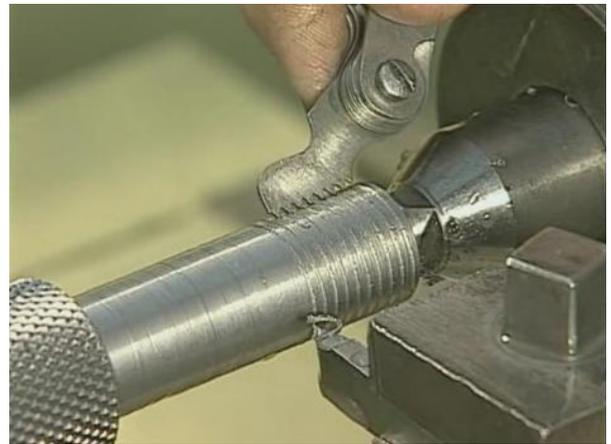
Figura 8-27 – Verificação do passo da rosca M25x2,5.
