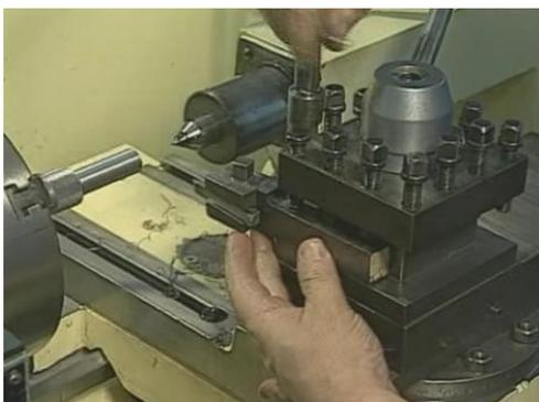
Figura 1-27 – Colocando a ferramenta de roscar na altura.
