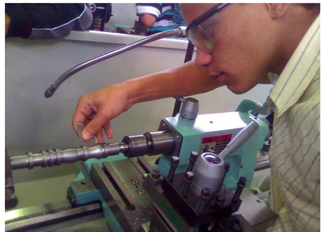
Figura 9-25.1 – Alternando entre verificar e retirar material.
