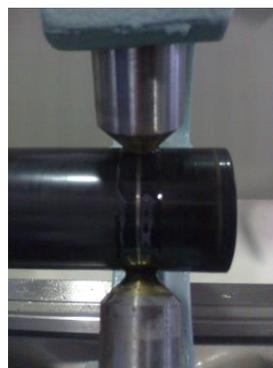
Figura 6-26 – Lubrificação dos contatos, por óleo ou graxa.
