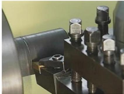
Figura 2-22.1 – Marcação do comprimento a ser usinado.
