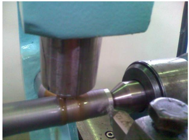
Figura 16-25 – início da usinagem com luneta móvel.
