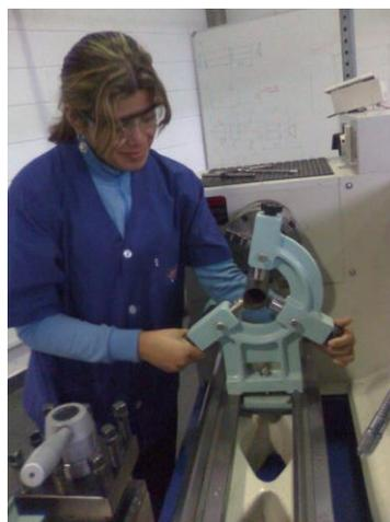
Figura 4-26 – Aproximação dos contatos que sustentam a peça.
