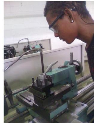
Figura 6-27 – Preparação para o início do processo de rosqueamento com o bico da ferramenta.
