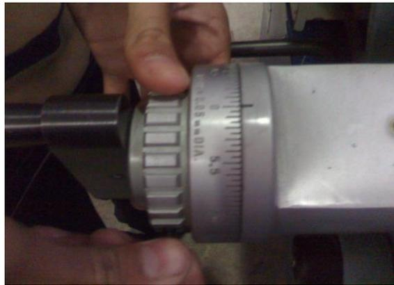
Figura 4-23 – Utilizando o anel graduado.
