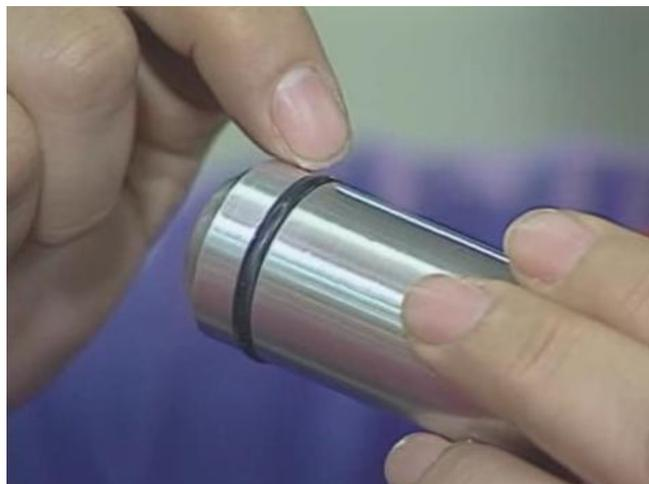
Figura 1-28.2 – Anel “O-ring” de borracha alojado no canal.
