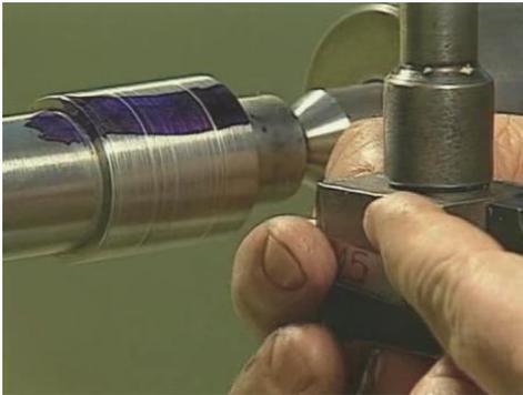
Figura 3-25.1 – Retirada da ferramenta de marcação.
