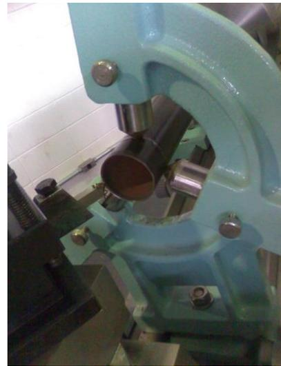
Figura 11-26 – Detalhe da operação de faceamento.
