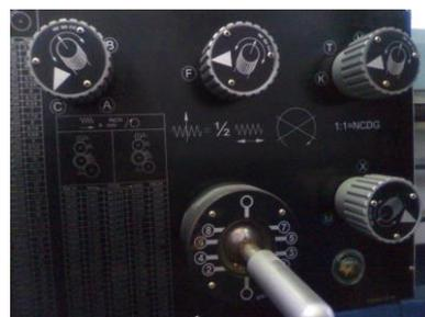
Figura 6-24 – Posicionamento das alavancas para passo 1,5mm.
